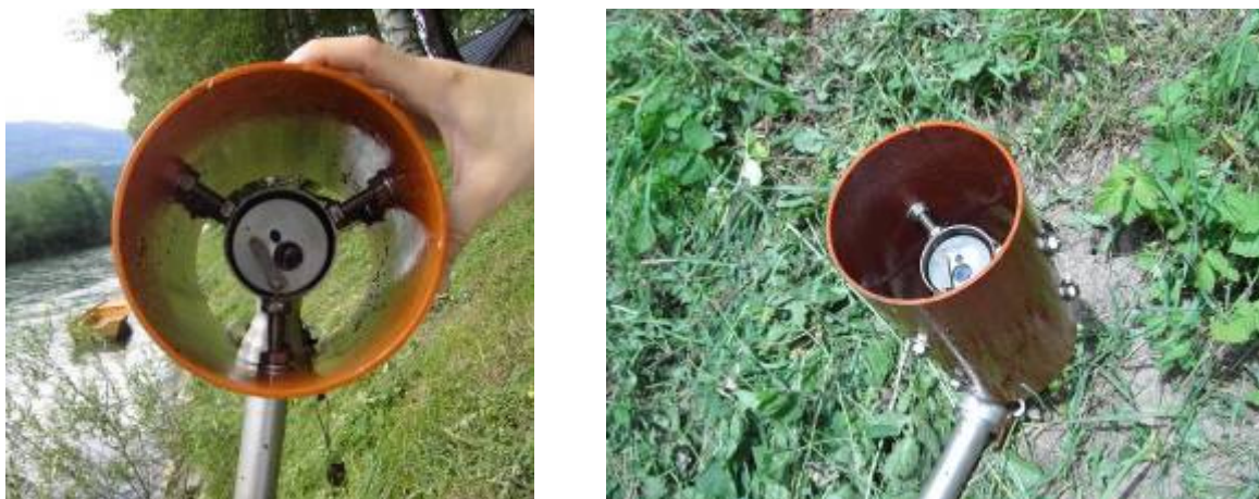
Abbildung 5: Konstruktive Maßnahme zur Verhinderung von Biofouling (Fotos: Kerschbaumsteiner)
