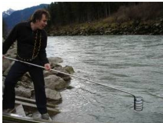
Abbildung 25: Probenentnahme mittels Schöpfgefäß am Seil und an der Stange (Foto links: Wagner, 2005; Foto rechts: Kremser, 2007)
