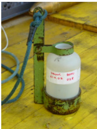
Abbildung 25: Probenentnahme mittels Schöpfgefäß am Seil und an der Stange (Foto links: Wagner, 2005; Foto rechts: Kremser, 2007)
