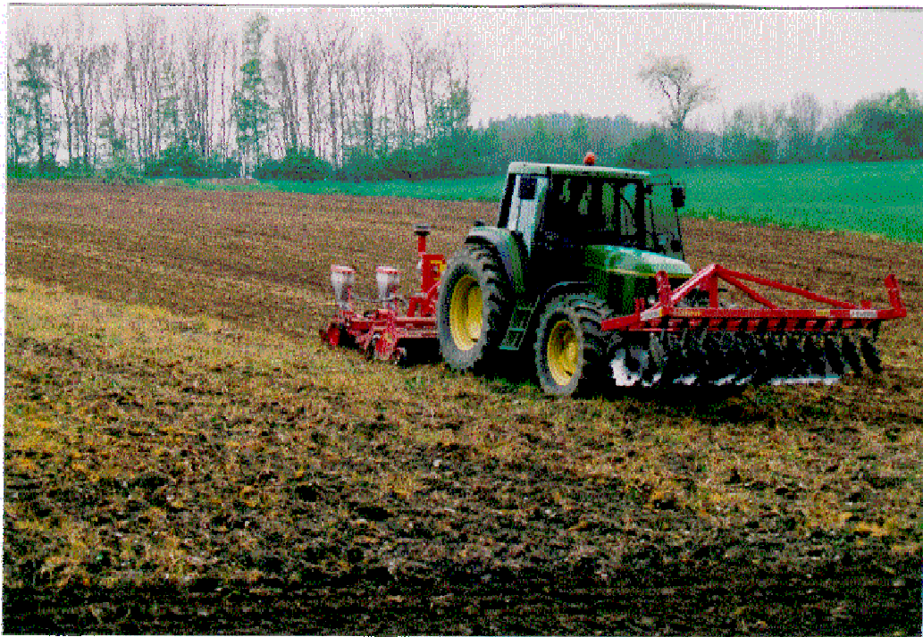
Abbildung 1: Mulchsaat Körnermais mit Zinkenrotor und Schlitzsämaschine – Warth (Bucklige Welt NÖ 1999)
