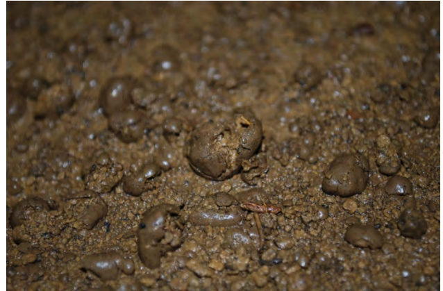
Abb. 4-109: Pseudopilierung von Bodenaggregaten als Resultat einer Homogenisierung bei erhöhtem Bodenwassergehalt, sowie Aufbrechen der pseudopilierten Aggregate während des Beregnungsprozesses.
