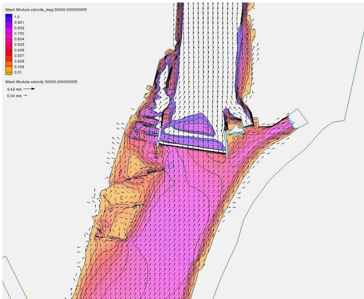
Abbildung 22: Fließgeschwindigkeiten bis 1 m/s und Fließvektoren im Planzustand bei Q = 30 \text{ m}^3/\text{s}
