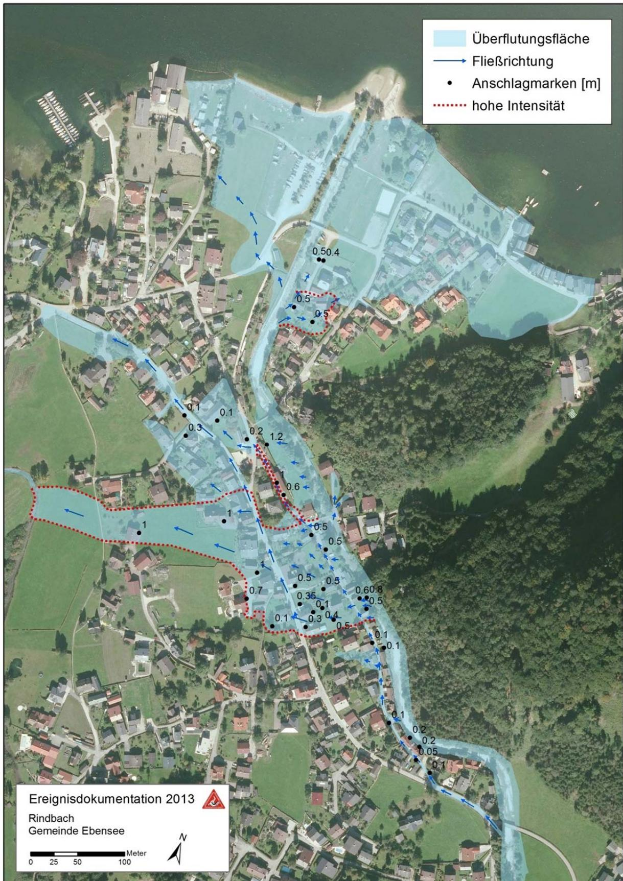
Abbildung 6-86: Überflutungsflächen mit Anschlagmarken und Fließwegen Rindbach (Quelle: IAN Report 155)
