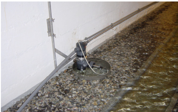
Durchflussmesszelle für die Trübungsmessung in einer Quellstube (Windener Quelle, Burgenland, © HD-Burgenland)
