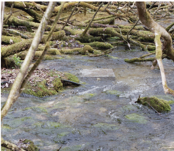
Messkorb mit Leitfähigkeits-, Temperatur- und Trübungssonde am Grund des Quellaustritts (Hirschbrunn, Oberösterreich, © Jutta Eybl)
