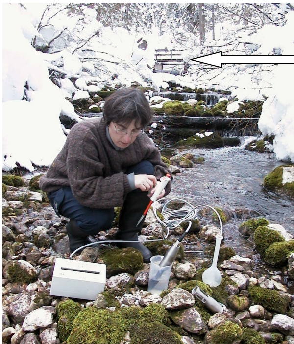
Salzverdünnungsmessung am Sagtümpel (Steiermark, © HD-Steiermark)
