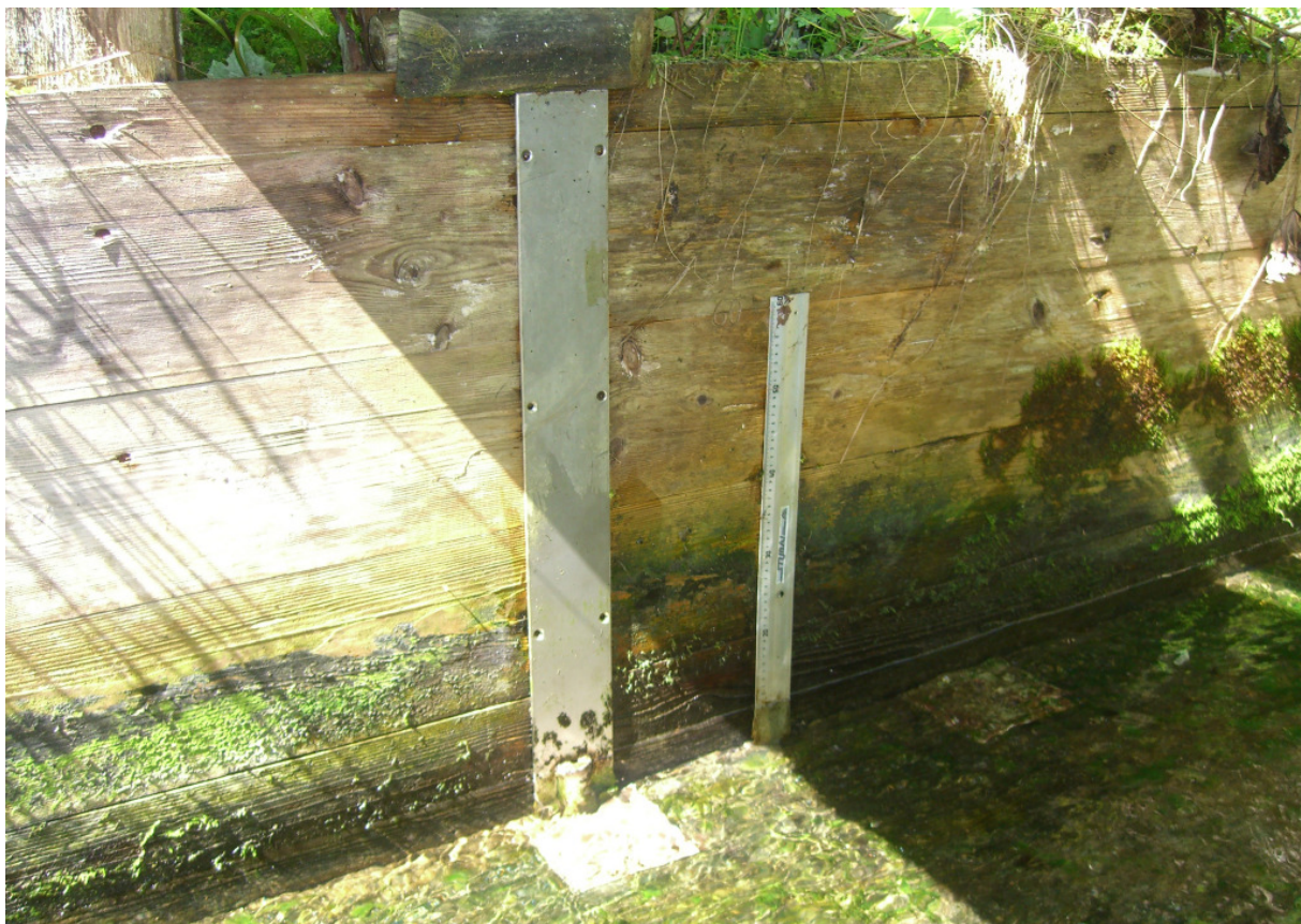
Drucksonde fluchtend in der Wand des Wehrkastens eingebaut, als Pegellatte dient ein Lineal – Ablesung auf 0,1 cm möglich (Sagtümpel, Steiermark, © HD-Steiermark)
