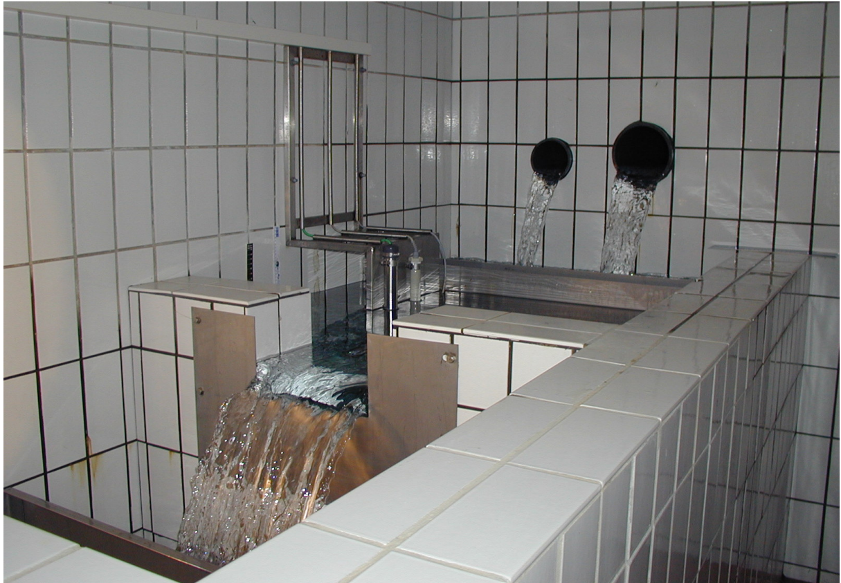
Messstelle in einer Quellstube mit Einzelsonden und Rechteckwehr (Geyerquelle, Oberösterreich, © Klaus Kaiser)
