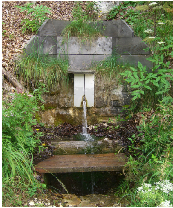
Messstelle mit NIROSTA-Messkorb mit schmalen Rechteckausschnitt zur Messung sehr kleiner Schüttungen und Unterbringung der Sonden (Erbsattelquelle, Steiermark, © HD-Steiermark)
