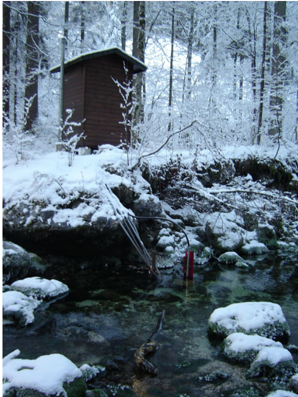
Messstelle mit natürlichem Messprofil, die Drucksonde zur Wasserstandsaufzeichnung ist an der Pegellatte montiert, (Teufelskirche, Oberösterreich, © Klaus Kaiser)
