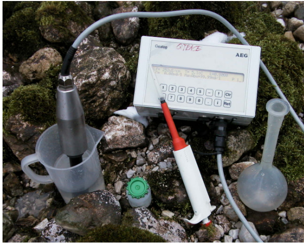
Utensilien für die Salzverdünnungsmessung : Leitfähigkeitssonde, Kalibrierflüssigkeit, Pipette, speziell konfigurierter Datensammler, Messkolben zur Entnahme des Quellwassers (© HD-Steiermark)
