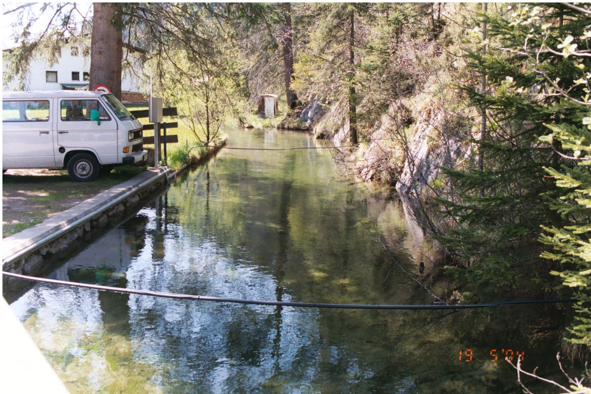
Messstelle mit natürlichem Messprofil, Aufzeichnung des Wasserstands und der Fließgeschwindigkeit mittels Drucksonde bzw. Laufzeitverfahren wegen auftretender Rückstau-effekte ausgelöst durch ein bachabwärts gelegenes Wehr, (Doserfall, Tirol, © Jutta Eybl)
