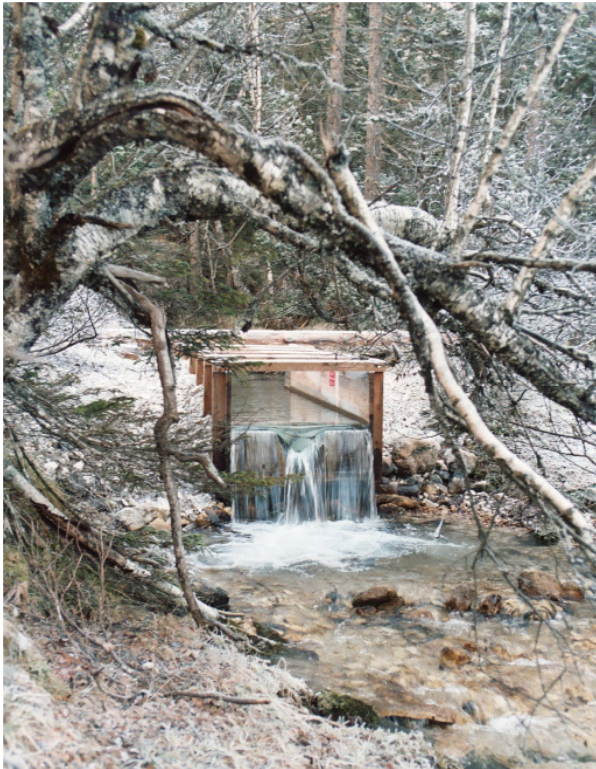
Messstelle mit Wehrkasten aus Lärchenholz und kombiniertem (gegliedertem) Wehr, (Landesmessstelle Isar-Ursprung, Tirol, © Jutta Eybl)
