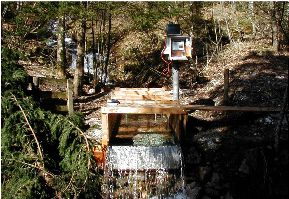
Messstelle mit Wehrkasten aus Lärchenholz und Rechteckwehr ohne Seitenkontraktion – Rehbockwehr, Datensammler in kleinem Schaltschrank, auf dessen linker Außenseite ist ein Solarpaneel montiert, Auslesung mittels Notebook (Katzensteigquelle, Tirol, © HD-Tirol)
