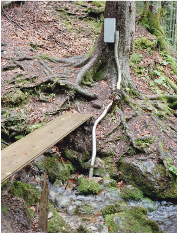
Abgesetzte Station, Messung von Temperatur und Leitfähigkeit nahe einer Austrittsstelle in einiger Entfernung vom Messwehr zur Schüttungserfassung (Schreiende Brunnen, Tirol, © Jutta Eybl)
