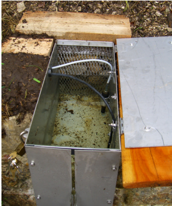
Messstelle mit NIROSTA-Messkorb mit schmalen Rechteckausschnitt zur Messung sehr kleiner Schüttungen und Unterbringung der Sonden (Erbsattelquelle, Steiermark, © HD-Steiermark)
