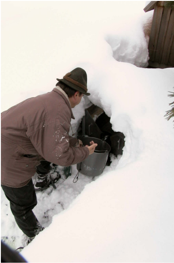
Füllzeitmessung an der Edelrautenquelle (Steiermark, © HD-Steiermark)
