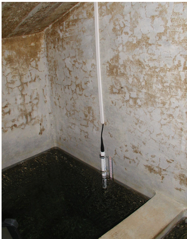
Messstelle in einer Quellstube mit Multiparametersonde (Lastalquelle, aufgelassene Messstelle, Tirol, © HD-Tirol)
