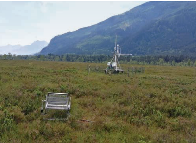
Die Gasflussmessanlage der Universität Wien im Pürgschachen Moor dient der Bestimmung der Kohlenstoffspeicherung und des Treibhausgasumsatzes des Moors. © A. Maier
