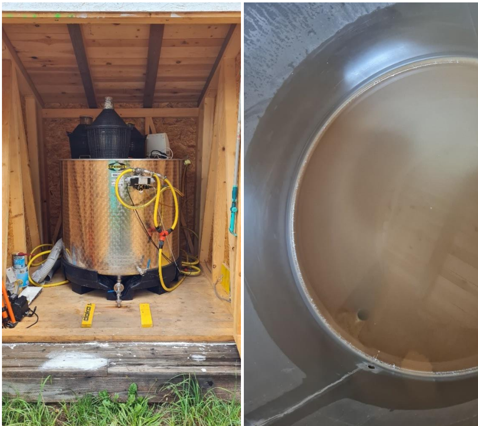
Abbildung 5 Large Volume Sampler (LVS) an der Raab; links der 1000 L Behälter, rechts die dekantierte Schwebstoffprobe im Behälter
