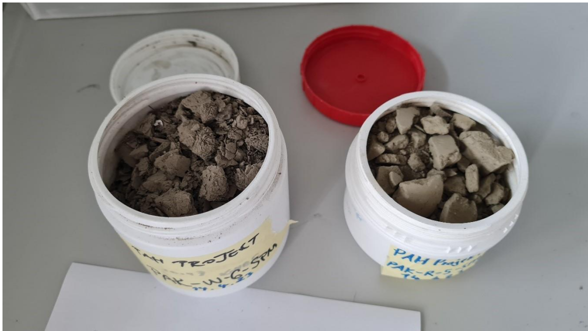
Abbildung 7 Lyophilisierte Schwebstoffproben, links von der Wulka, rechts von der Raab
