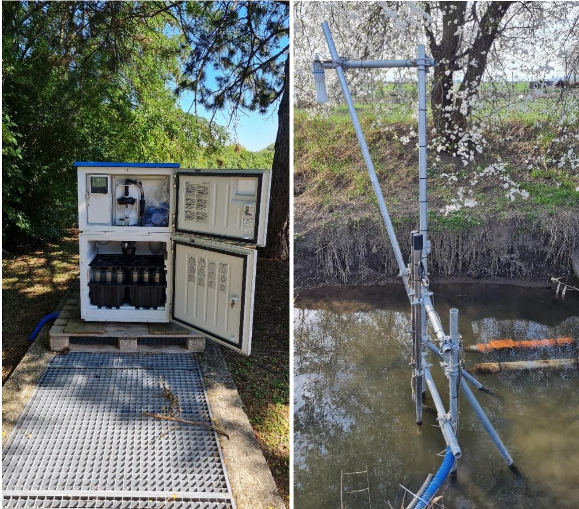
Abbildung 3 Gewässermonitoringstation am Nodbach: links der Autosampler (Probenahmeeinrichtung oben und Probenahmegefäße unten), rechts die Sensoren und die Phillips-Sammler im Gewässer
