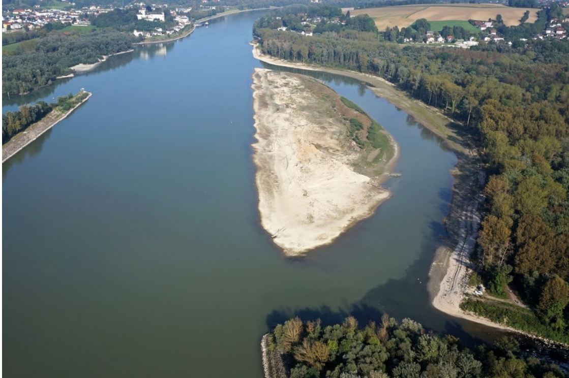
Abb. 1 Völlig neu geschaffenes Insel-Nebenarmsystem Marktau in der Stauwurzel KW Abwinden-Asten im September 2014 (ezb – Technisches Büro Zauner GmbH).
