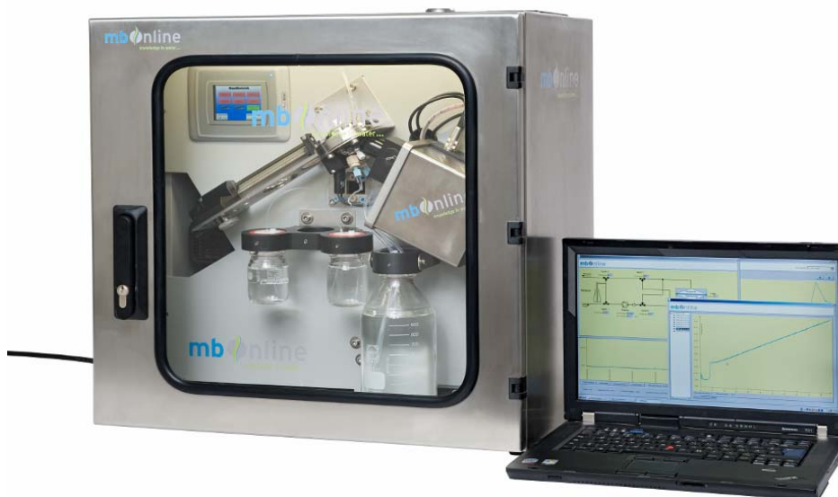
Abbildung 17 COLIGUARD® EC.hs Messgerät und Laptop mit Software; Komponenten im Gerät: der Reaktor mit Filterplatte und Verstelleinrichtung (liegt schräg von links unten nach rechts oben), rechter Hand die fluoreszenzoptische Messeinheit, darunter die Reagenzien und die Reinigungslösung
