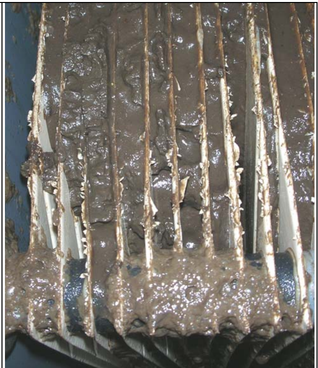
Ultra L1: Fast alle Plattenzwischenräume sind mit Filterkuchen total verblockt.
