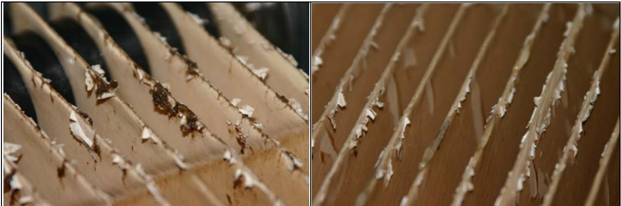
Abbildung 15 Ablöseerscheinungen an den Rändern der Membranplatten der Ultra L1 bei der zweiten Reinigung am 26.02.2009.
