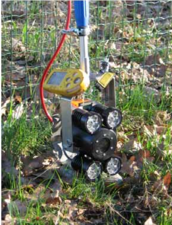
Abbildung 10 - Elektronischer Spiegel mit Gaswarngerät
