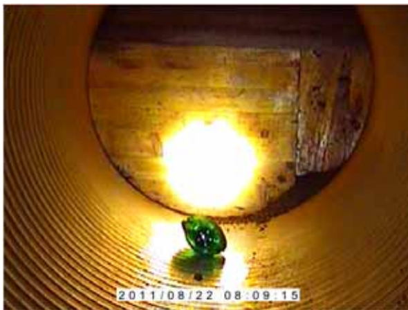
Abbildung 50 - BBE-C: Andere Hindernisse, allgemein; Nennw.-Red.=1%; Kreisprofil DN 800 - Polypropylen; elektr. Spiegel 1
