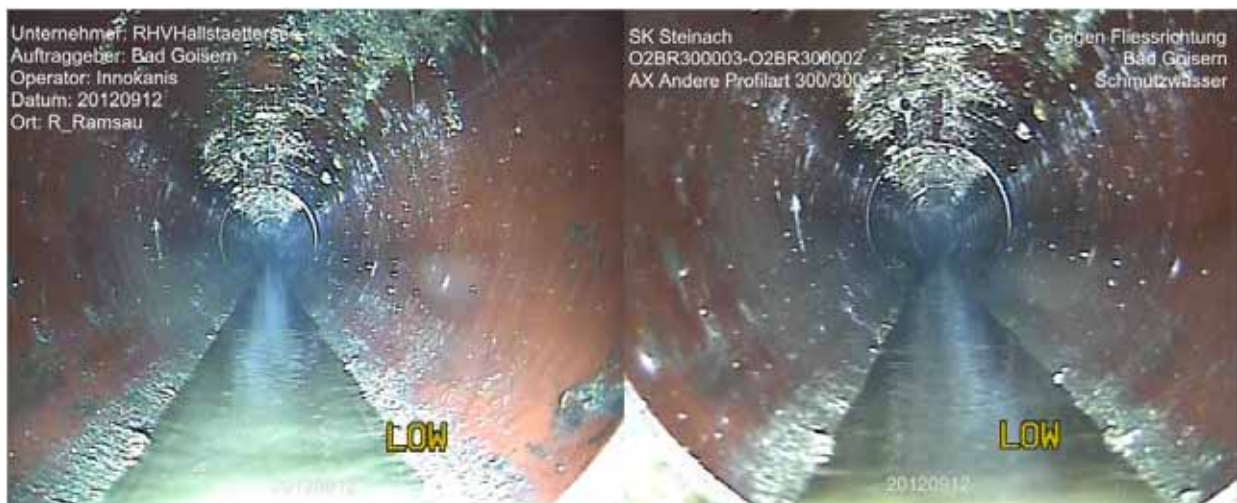
Abbildung 141 - Einblendung der Stammdaten in das Videobild
