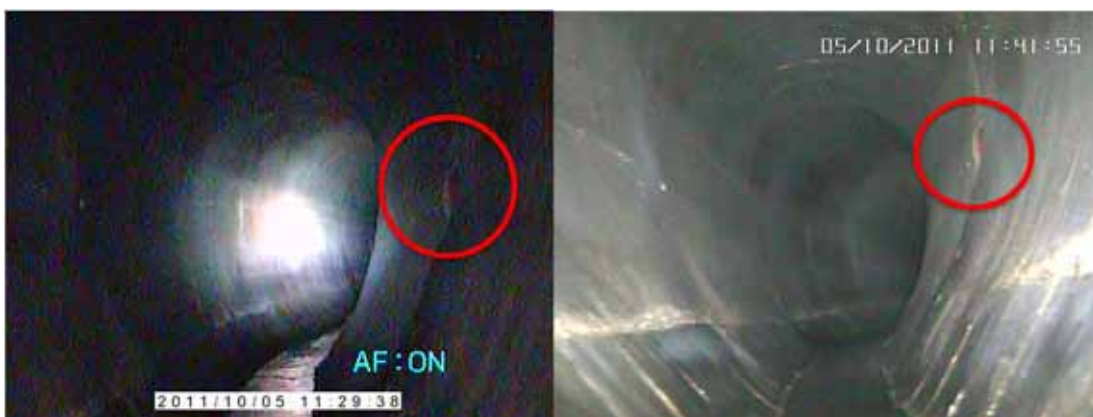
Abbildung 102 - punktuell Licht (links) vs. Streulicht (rechts)
