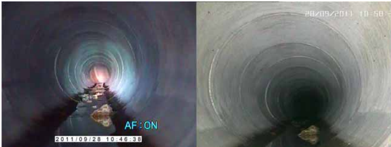
Abbildung 101 - punktuell Licht Spiegelmodell 1 (links) vs. Streulicht Spiegelmodell 2 (rechts)
