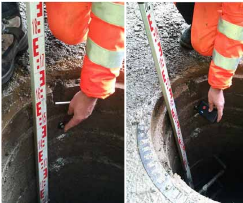
Abbildung 152 - links: RFID Chip zur Schachtidentifikation; rechts: RFID Lesegerät zum Auslesen der Schachtbezeichnung (BOKU Wien, 2012)
