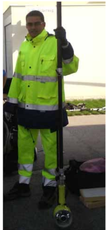
Abbildung 178 - iPEK QuickView X (Prototyp) Feldeinsatz
