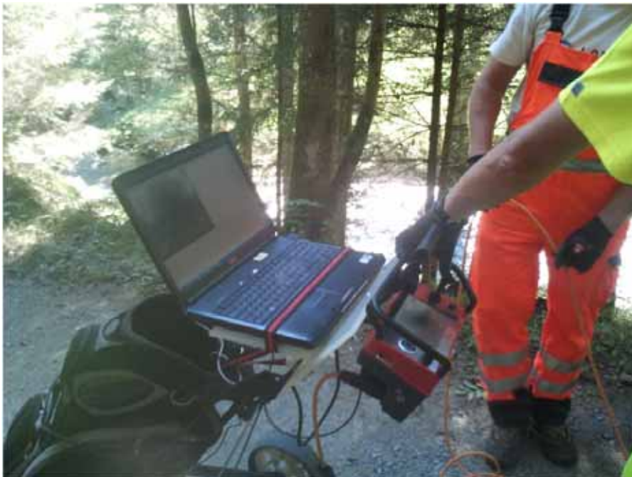
Abbildung 209 - Golf-Caddy mit Inspektionslaptop und Steuereinheit des Kameramodells MesSen Nord STV3
