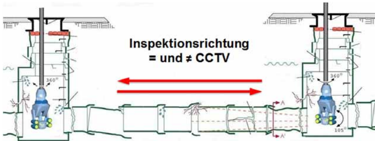
Abbildung 12 - Elektronischer Spiegel: Gleiche sowie entgegengesetzte Inspektionsrichtung wie herkömmliche TV-Inspektion (adaptiert nach Aquadata, 2012)
