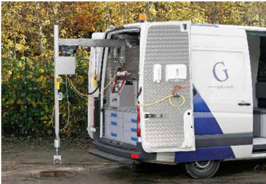
Abbildung 22 - Ganymetsystem an einem Fahrzeugkran montiert (Gullyver, 2014)
