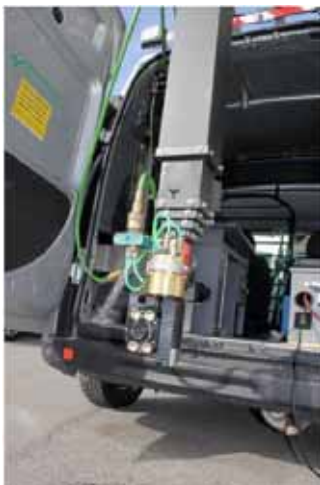
Abbildung 21 - Schachtinspektionskamera RZL 90° (JT Elektronik, 2014)
