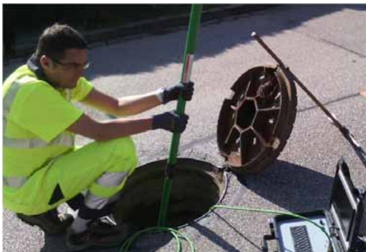
Abbildung 192 - JT-Elektronik Fast Picture Inspektionsdisplay 3
