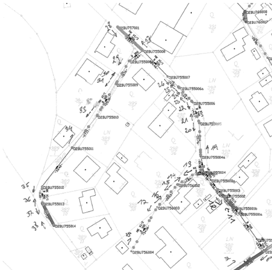
Abbildung 138 - Zuordnung der Schacht-Zoom-Kamera Videos zu den untersuchten Haltungen
