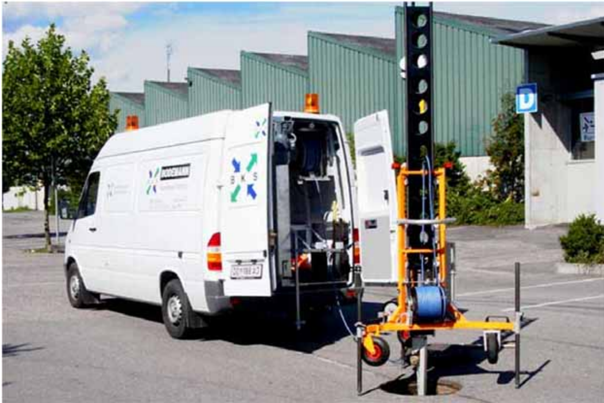
Abbildung 18 - Inspektionsfahrzeug verbunden mit der Vermessungseinheit (Bodemann GmbH, 2008)
