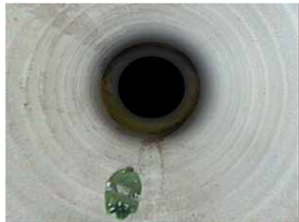
Abbildung 51 - BBE-C: Andere Hindernisse, allgemein; Nennw.-Red.=1%; Kreisprofil DN 800 - Polypropylen; Scan System 1
