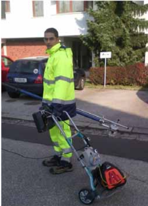
Abbildung 179 - Ritec Schachtkamera Feldeinsatz
