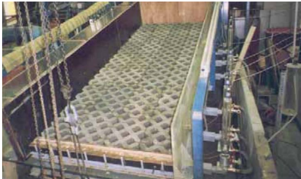
Abbildung 2-9: Verbundene Rasengittersteine in einer Kipprinne im Labor
