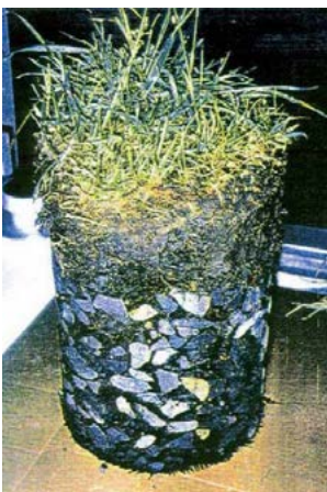
Abbildung 2-10: Bohrkern aus einem begrüntem MastixSchotter-Deckwerk
