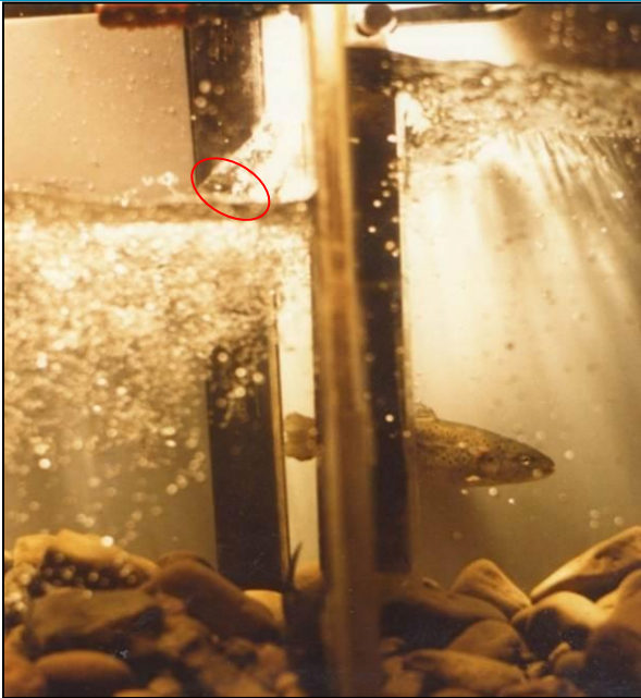
Abbildung 14: Schlitzströmung mit aufsteigender Bachforelle (GEBLER 1991); Bereich der höchsten FG ist rot gekennzeichnet
