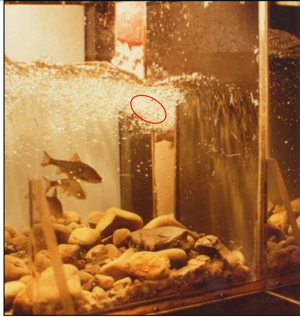
Abbildung 15: Standort der Rotaugen im Strömungsschatten des Umlenkblockes, von hier aus starten sie beim Durchschwimmen des Schlitzes (GEBLER 1991); Bereich der höchsten FG ist rot gekennzeichnet, deutlich ist auch die Wirkung der Turbulenz anhand der Körperhaltung der Rotaugen zu erkennen
