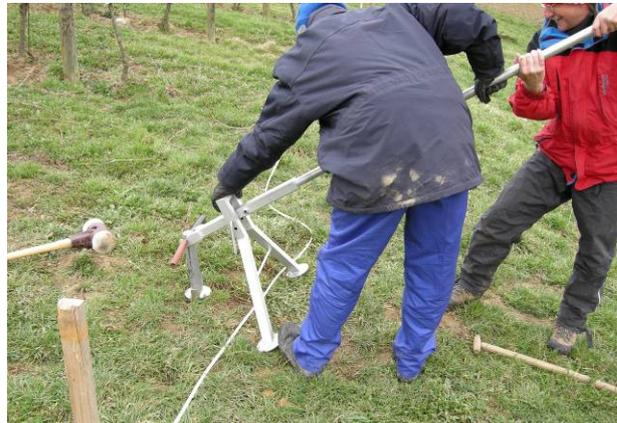
Abb. 3-8: Entnahme von Bodenproben zur Bestimmung von Elementkonzentrationen und Lagerungsdichten
