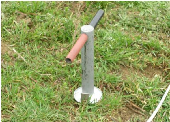
Abb. 3-6: Entnahme von Bodenproben zur Bestimmung von Elementkonzentrationen und Lagerungsdichten
