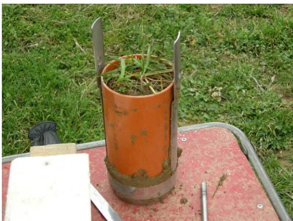
Abb. 3-7: Entnahme von Bodenproben zur Bestimmung von Elementkonzentrationen und Lagerungsdichten
