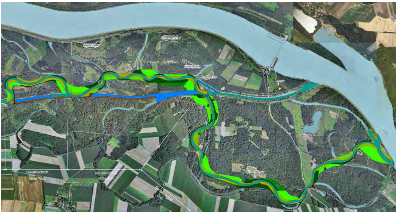
Abbildung 31: Übersichtsgrafik Neuer Traisenunterlauf (grünes Band) im Vergleich zu geradliniger Traisen heute (LIFE+ Projekt „Traisen“). Foto: T. Kaufmann
