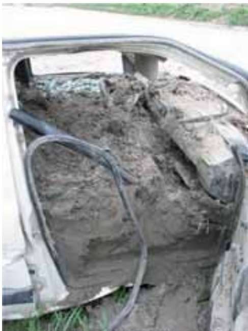
Abbildung 14-9: Sedimentablagerung in einem Pkw (Quelle: BOKU IWHW).
