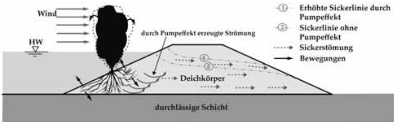
Abbildung 6-15: Durch Bewegung von Bäumen erhöhte Sickerlinie (nach HASELSTEINER & STROBL 2005).
