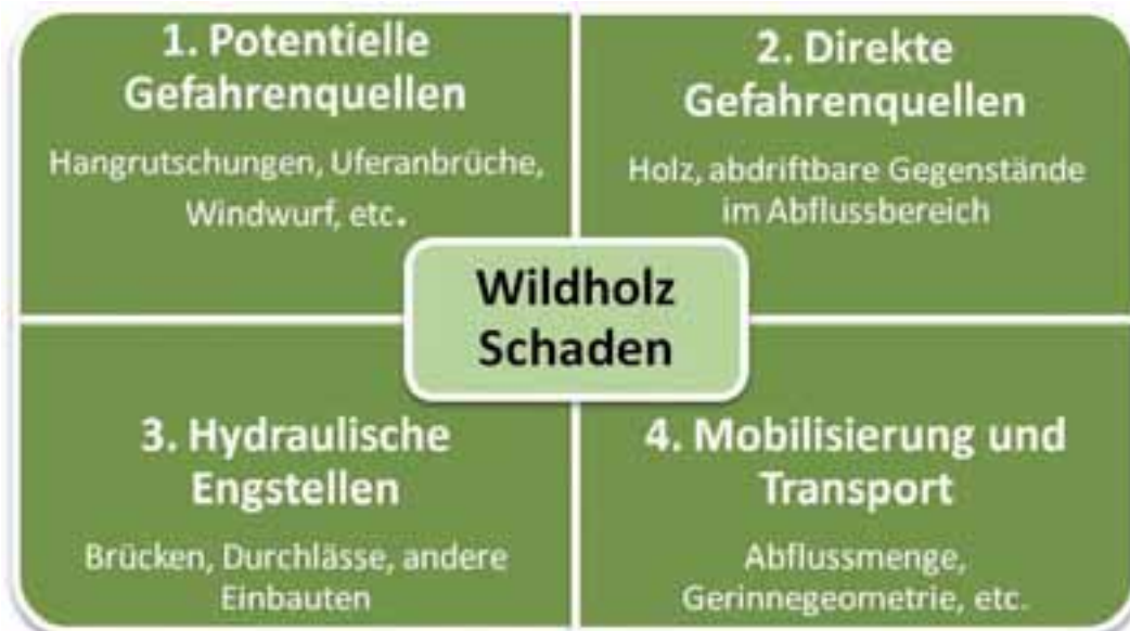
Abbildung 5-16: Wildholzschäden können durch ein Zusammenwirken von vier verschiedenen Faktoren entstehen.
