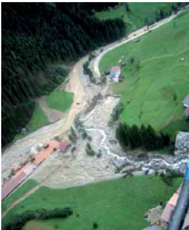
Abbildung 14-13: Geschieberückstau in Zubringer: Kappl, Mündung Seßladbach in die Trisanna/Tirol. (Quelle: ASI Tirol).
