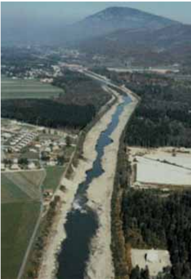
Abbildung 5-13: Sohdurchschlag an der Salzach aus den 1960er Jahren. (WRs 2000).
