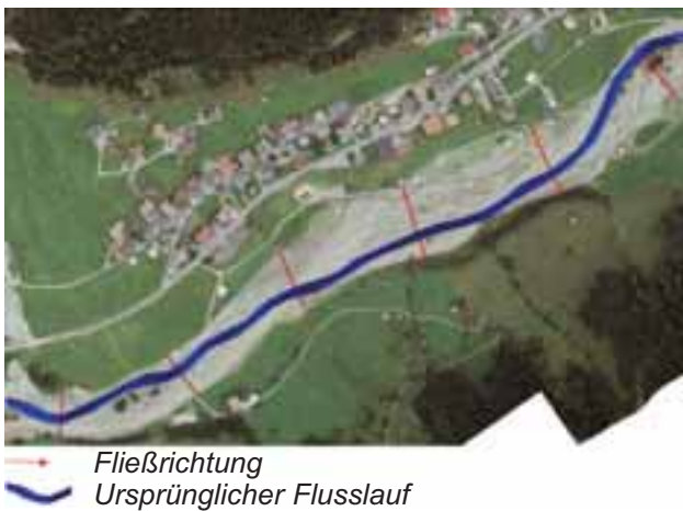
Abbildung 14-10: Überlagerung der Trisanna vor und nach dem Hochwasser 2005 bei Mathon/Tirol. (Basis: Land Tirol, IWHW).
