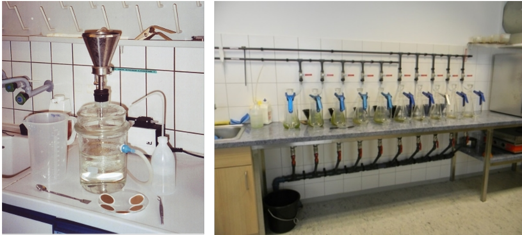
Abbildung 16: Filtriergerät mit Zubehör und Vakuumpumpe im Hintergrund (Foto links: Stimpfl, 2006); Vakuumpumpe der VHP (Foto rechts: Kerschbaumsteiner)
