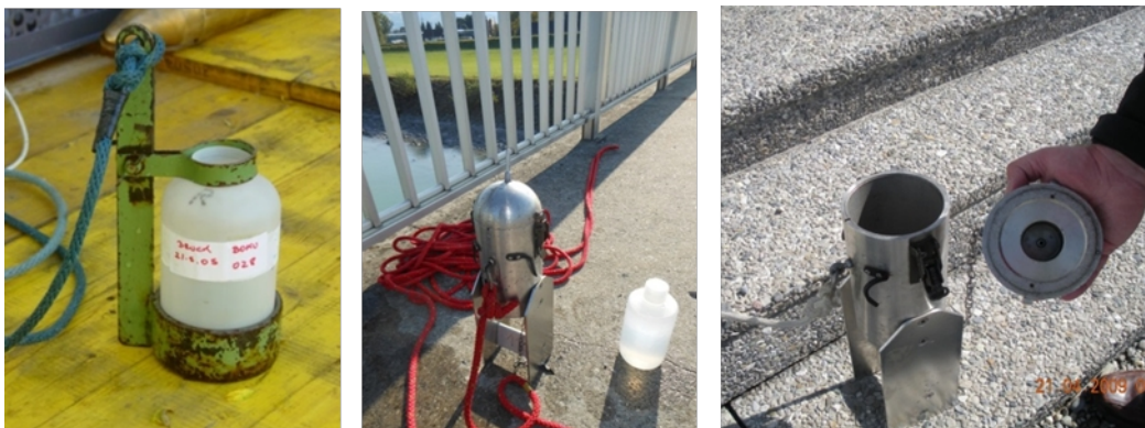
Abbildung 32: Foto links: Probenentnahme mittels Probenflasche am Seil (Foto links: Wagner, 2006); Foto Mitte und rechts: Sammler des Bundesamts für Umwelt, Schweiz (Amt der Vorarlberger Landeregierung)
