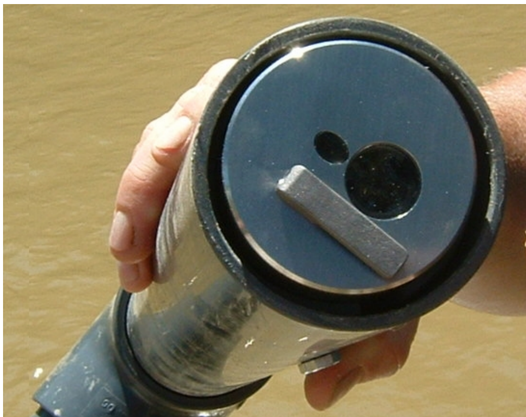
Abbildung 36: Sonde Solitax ts-line in Schutzrohr und mit Wischer (Foto: Hauer, 2007)
