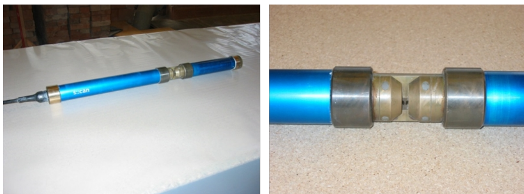
Abbildung 37: links: Spectro::lyser™ der Firma s::can, rechts: Messpfad des Spectro::lyser™ (Fotos: Bittner, 2008)
