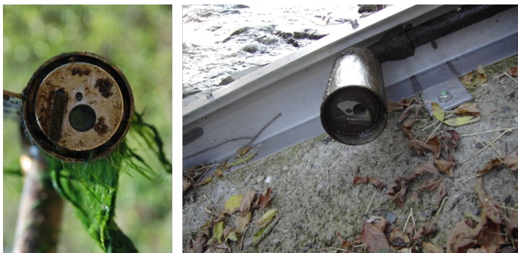
Abbildung 7: Biofouling an Sonden (Foto links: Wakolbinger, Foto rechts: Kerschbaumsteiner)
