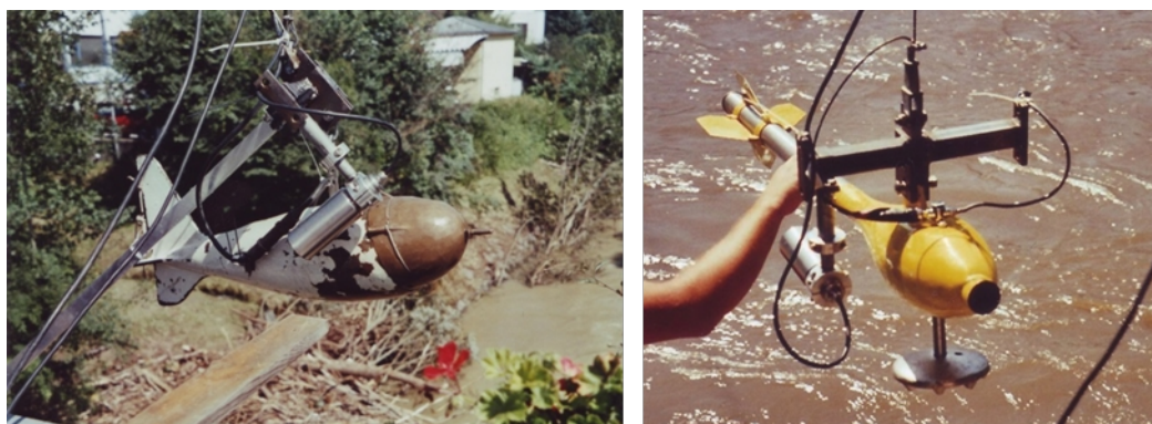
Abbildung 2: Trübungssonde an Probenentnahmegesetz (links) bzw. an Gewichtsstück des Seilflügels (rechts) (Fotos: Stimpfl)
