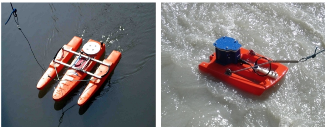
Abbildung 38: links: Geräteträger „Trimaran“ des ADCP-Gerätes „Workhorse Rio Grande ZedHed“ (Foto: Haimann, 2007); rechts: ADCP-Gerät „Stream Pro“ der Firma RD Instruments (Foto: Haimann)
