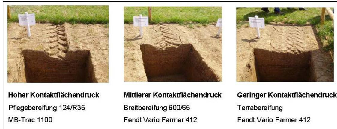
Abbildung 15: Auswirkungen unterschiedlicher Bereifung auf die Spurrillenbildung (aufgenommen bei den DLG-Feldtagen 2006 in Hanau; Hessen)
