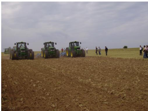
Abbildung 18: Gleiche Bedingungen beim Grubbern mit unterschiedlicher Bereifung (rechts: Standardbereifung, Mitte: reduzierter Reifendruck; links: Zwillingsbereifung)
