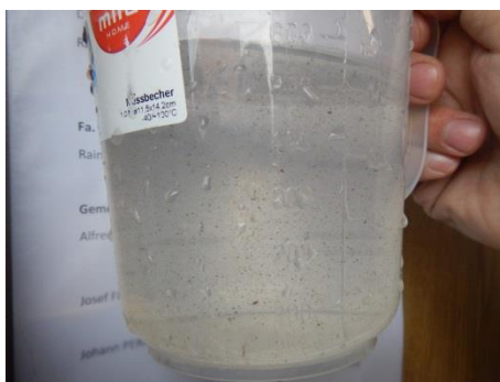
Abbildung 23: Partikel im rückgespülten Wasser
