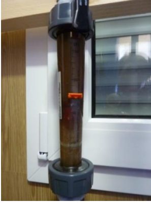
Abbildung 27: Durchflussmesser mit Biofilm
