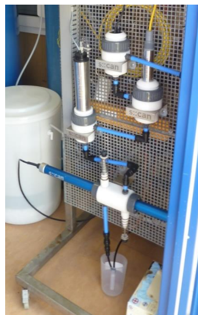
Abbildung 21: Messgeräte zur kontinuierlichen Messung der Wasserqualität
