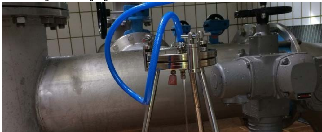
Abbildung 12: Darstellung einer Filtrationseinheit für die Vor-Ort-DNA-Aufkonzentration
