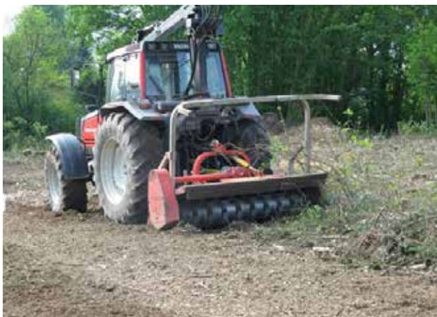
Beim Mulchen und Schlägeln mittels Forstmulcher wird das Schnittgut auf der gemähten Fläche liegen gelassen. © land.und.wasser
