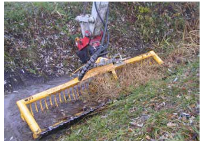
Mähkorb zur Entfernung von Gras- und Schilfbewuchs an Böschungen und Grabensohle. © Flussbauhof Vorarlberg
