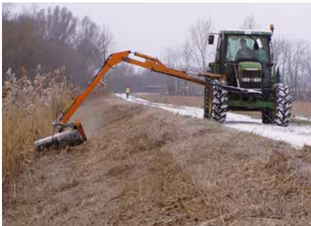
Schlegelmäher können durch ihre robuste Bauweise auch Äste und Holzstücke zerkleinern. © land.und.wasser
