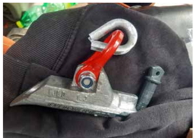
Erdanker mit eingehängter Kausche zum Schutz des Stahlseils.
