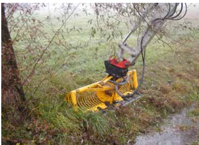
Mähkorb für die Unterwasser- oder Böschung-Mahd, © Flussbauhof Vorarlberg
