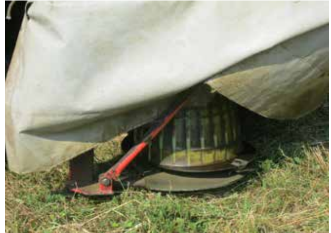
Scheibenmäherwerk: Auf einem Trägerbalken rotieren flache Mähscheiben, an denen jeweils zwei oder drei Einzelmesserklingen befestigt sind. © land.und.wasser
