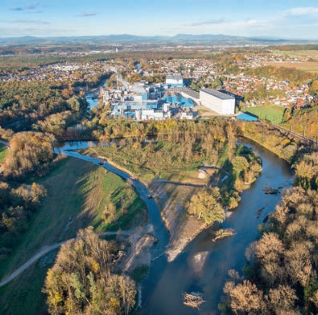
Foto 7.6: Im Zuge des LIFE-Projekts Mostviertel geschaffene Aufweitung und Nebenarm im Stauwurzelbereich des KW Hausmening/Ybbs/NÖ. (© Haslinger extremfotos)
