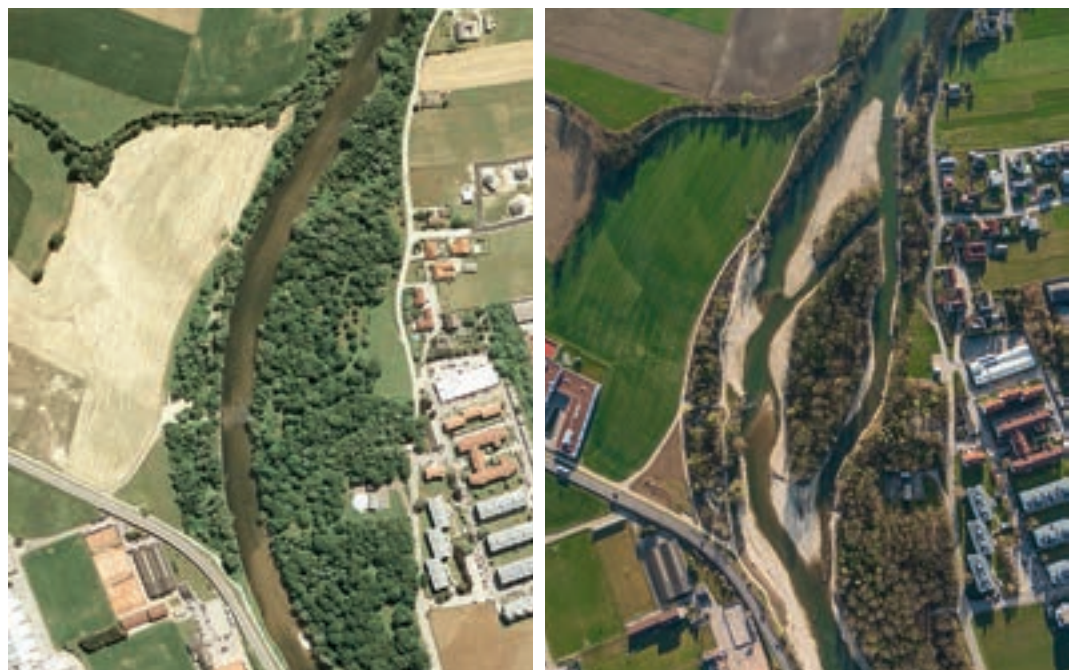
Fotos 5.56–5.57: Ybbs bei Amstetten/NÖ: Errichtung eines Seitenarmes, links vor und rechts nach Bau. (© NÖGIS, Haslinger extremfotos)
