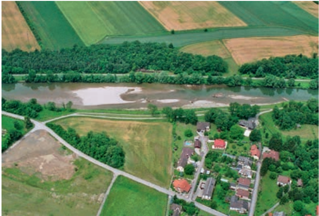
Foto 5.53: Aufweitung des Flussbettes auf die doppelte Regulierungsbreite an der Traisen (Reith/NÖ). (© ezb)
