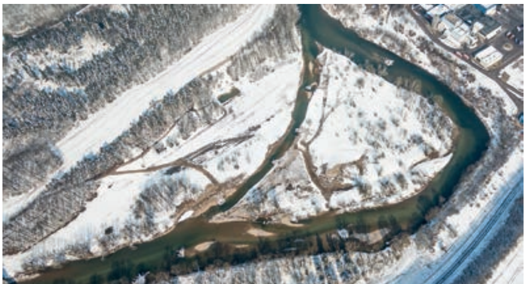
Foto 5.65: Permanent durchflossener Nebenarm mit dynamischer Selbstentwicklung an der Ybbs bei Hausmending/NÖ. (© Haslinger extremfotos)
