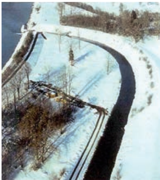
Fotos 4.42–4.43: Mündung Liechtensteiner Binnenkanal mit unpassierbarer Mündungsrampe vor (links) und niveaugleicher Einmündung nach Fertigstellung (rechts). (© Amt für Umweltschutz/FL)
