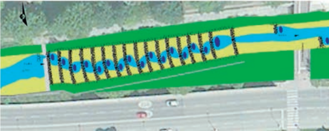
Abb. 4.1: Lageskizze aufgelöste Sohlrampe Wienfluss, mit regelmäßiger Becken-Riegel-Struktur. In jeder Einzelschwelle ist eine deutliche Niederwasserrinne ausgebildet. (© ezb)
