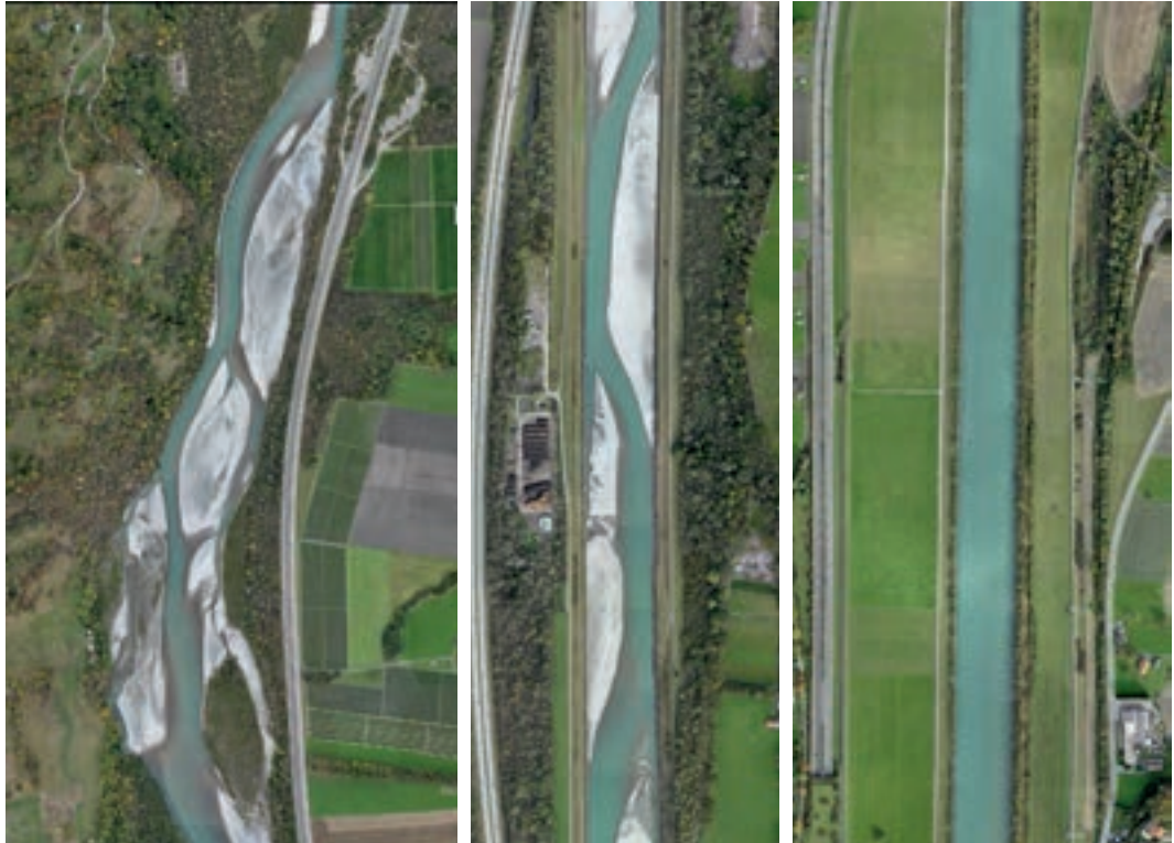
Abb. 9.2: Untersuchungsstrecken für die Schwall-Habitatmodellierung am Alpenrhein: naturnaher Abschnitt (links), regulierter Bereich mit alternierenden Kiesbänken (Mitte) und eng regulierter Abschnitt ohne Kiesbänke (rechts) (vgl. Abb. 9.3 und Text folgende Seite; © IRKA, 2012)
