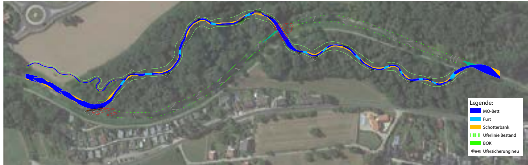
Abb. 5.18: Wiederherstellung einer pendelnd-mäandrierenden Linienführung durch Neuanlage großzügiger Flussbögen im Gewässerumland, Laabenbach/Gr. Tulln/NÖ. (© ezb)
