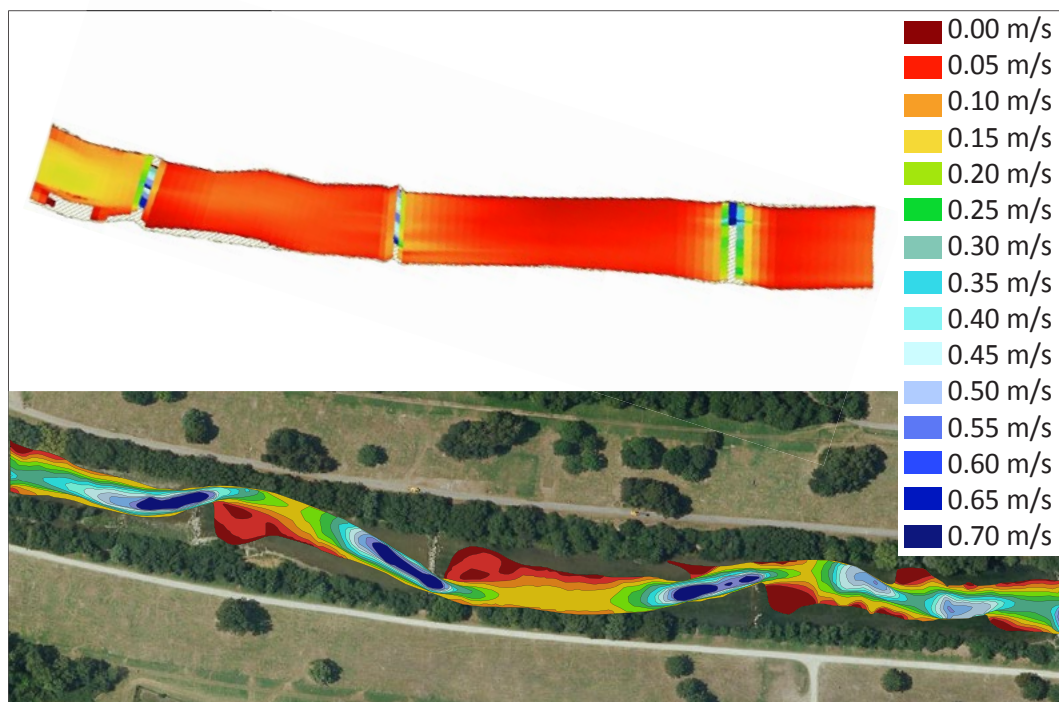
Abb. 8.4: Fließgeschwindigkeiten bei Restwasserabfluss im bestehenden Regulierungsprofil (oben, © TB Spindler) und mit Strukturierung (unten, © ezb und © DonauConsult) (entsprechend hydraulischer Modellierung).
