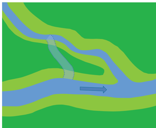
Abb. 4.26: In Anlehnung an den gewässertypischen Zustand wird der mündungsnaher Bereich des Seitengewässers mit einer der mäandrierenden Linienführung entsprechenden Lauflänge ausgeformt und flussab verlegt. (© ezb)
