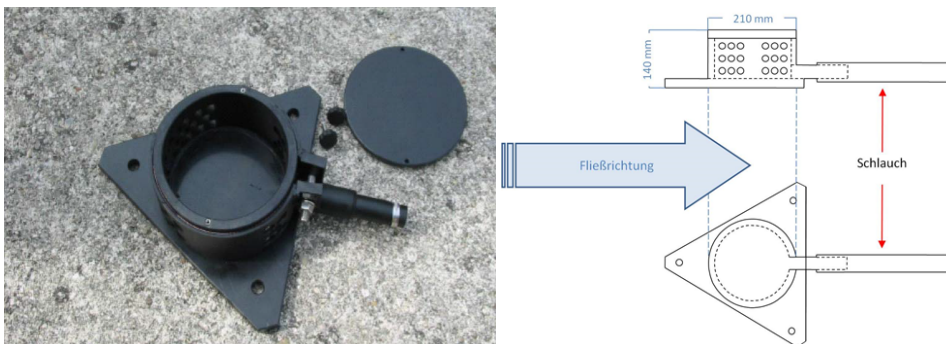
Abbildung 74: Geöffneter Einströmkopf der Schwebstofffalle und schematische Skizze des Einströmkopfes (aus Umweltbundesamt, 2012).
