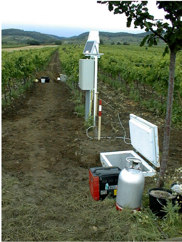
Abbildung 2: Ansicht einer Messstelle mit Absauganlage für Bodenlösung (Sickerwassersammler) im Bauzustand mit Wetterstation
