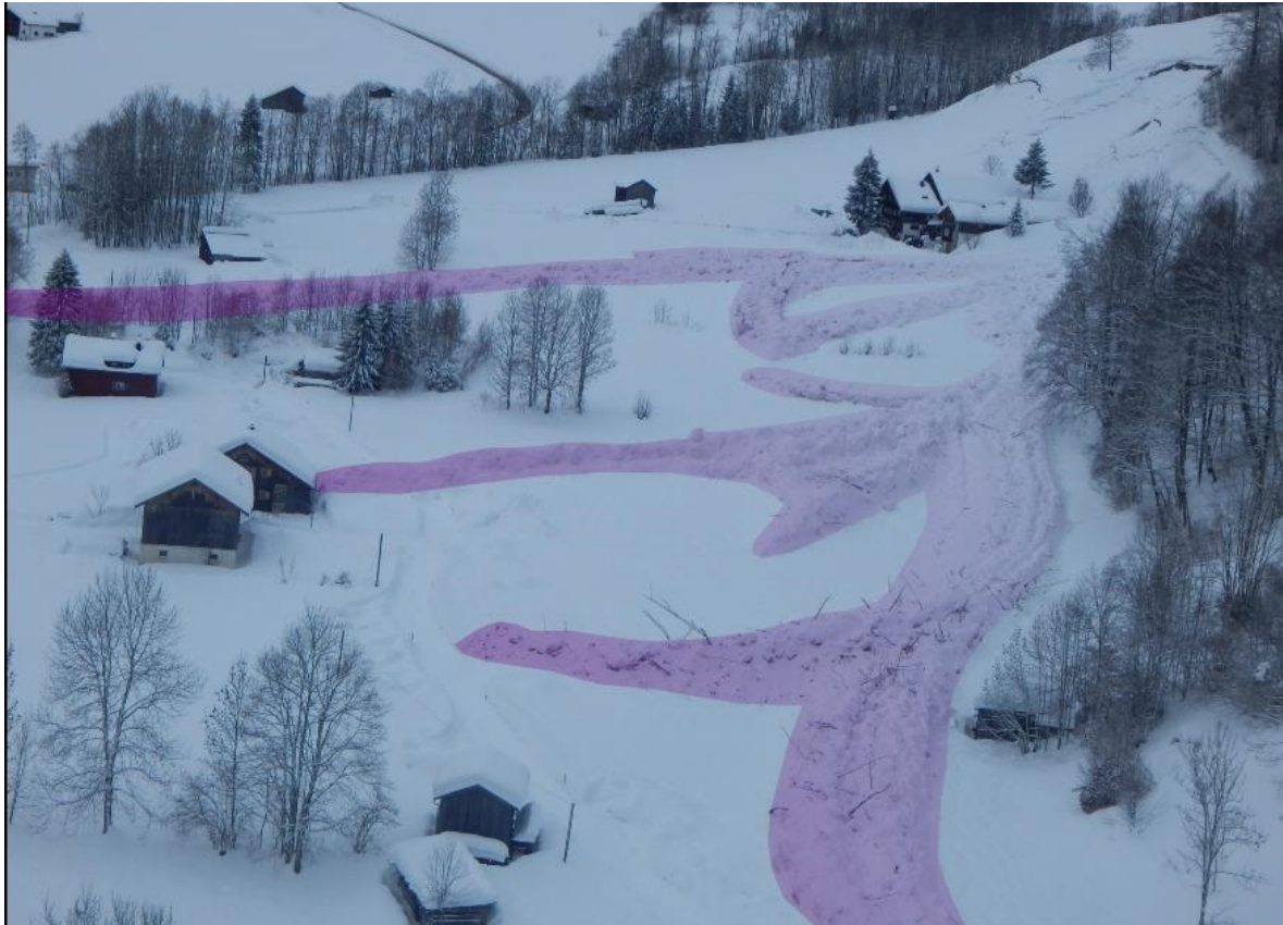
Abbildung 66: Großräumige Gleitschneebewegungen im Bereich der Tierreihen-Lawine, Schröcken
