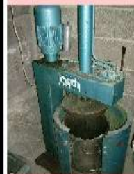
Dosenpresse zur Verringerung des Abfallvolumens
