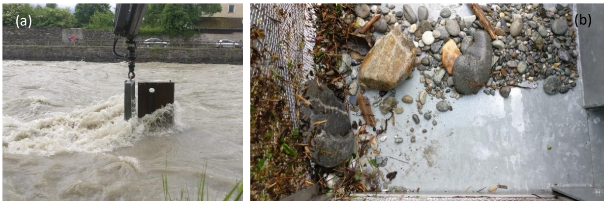
Abbildung 18: Geschiebemessung am 12.06.2019, Iselsteg/Isel
