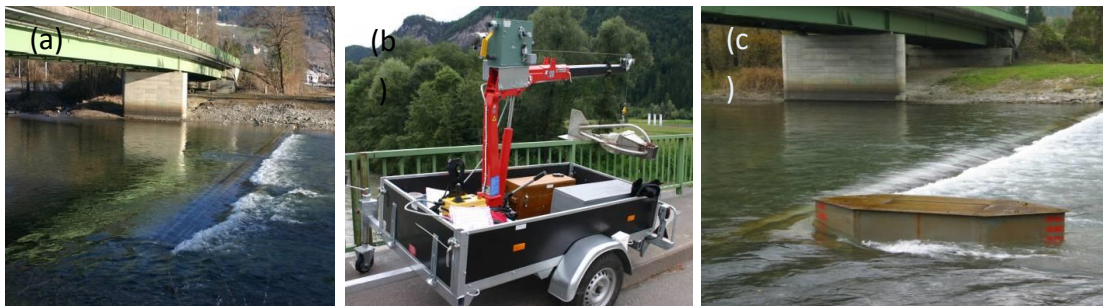
Abbildung 30: Messstation Dellach/Drau; Geophonanlage (a), Messanhänger (b), Hubfalle (c)
