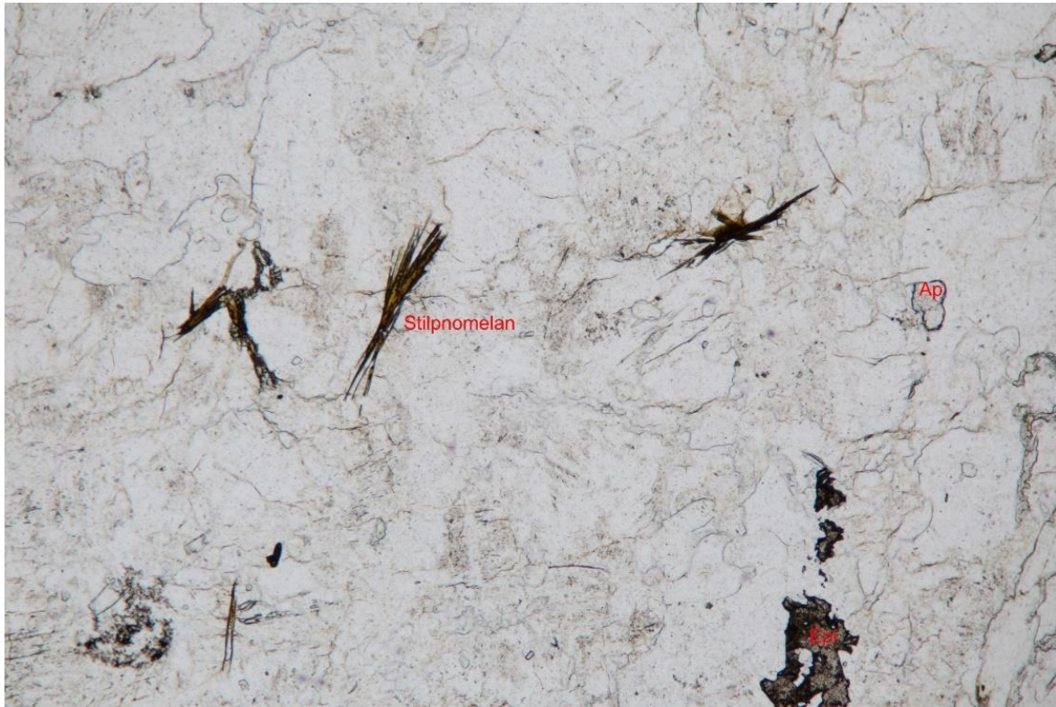
Abbildung 88: Schliff 320 (PPL); 5 x vergrößert; Bild: 3 x 2 mm faseriger Stilpnomelan in Plagioklas, Quarz und Kalifeldspat-Matrix
