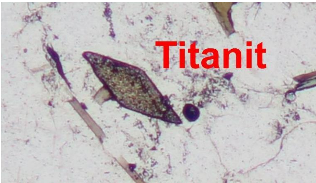
Abbildung 43: Schliff 314 (PPL); idiomorpher Titanit in Matrix, Größe Titanit: 0,32 mm
